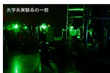
PL観測は、試料にレーザー等の光でエネルギーを与え、発生するキャリアの遷移過程で生じる発光を検出する手法である。この発光スペクトルを解析することで、キャリアの遷移機構や欠陥のエネルギー準位などの半導体の特性がわかる。
